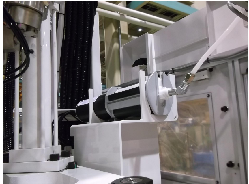
一液式样的简易型材料供给装置
